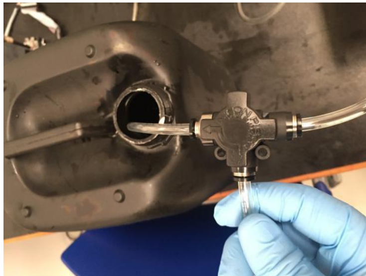
Рисунок 3: Трубка в канистре и переключатель для шприца
