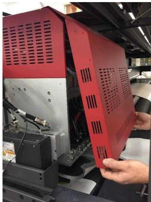
Рисунок 5-2: Снятие крышки каретки
