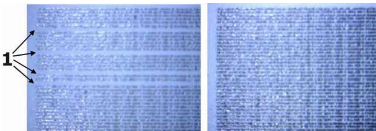
Плохое состояние сопел
