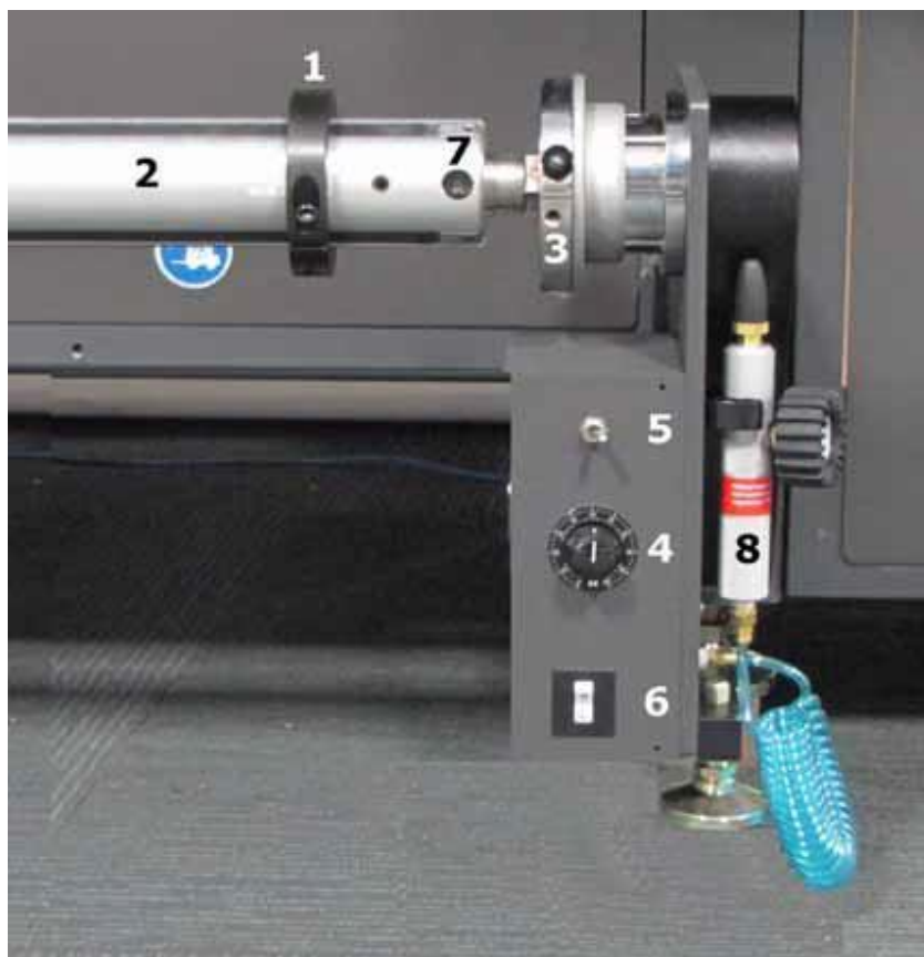
Рисунок 3 – 20: Панель управления размотчиком/намотчиком
