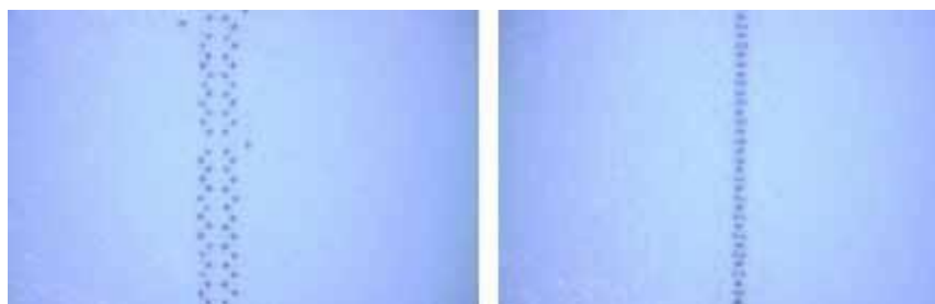
Рисунок 8 - 5: Микроскопическое изображение выравнивания двунаправленной печати
