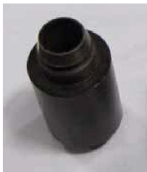
Рисунок 9 – 2: Калибровочный вес имитирующий пустую емкость
