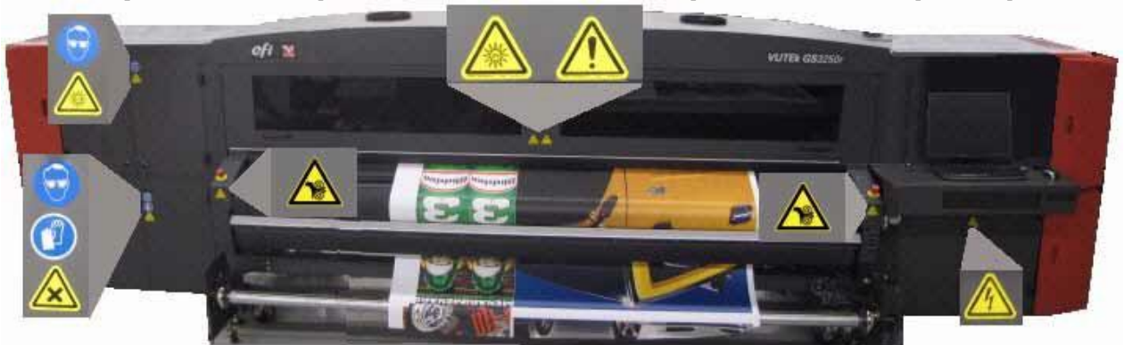
Рисунок 2-3: Вероятная опасность в передней зоне принтера
