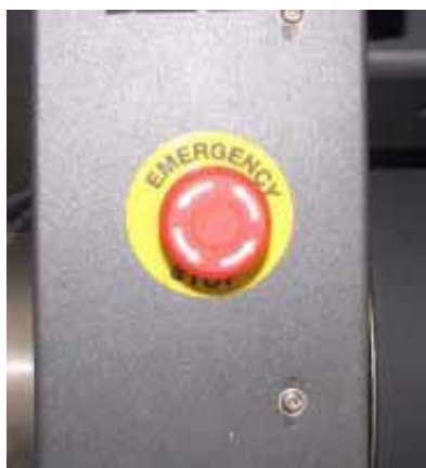
Рисунок 2-1: Кнопка аварийной остановки
