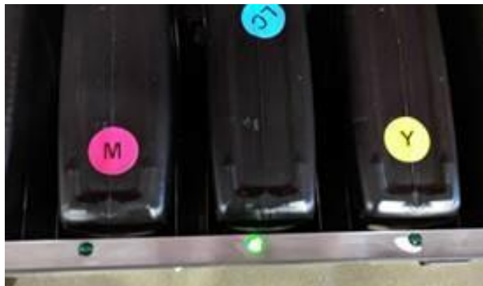
Рисунок 7-4: Зеленый индикатор показывает, что RFID считыватель разрешил заливать краску в этот канал
