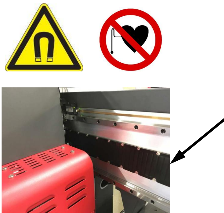
Рисунок 2-2 Мощные магниты (линейный двигатель)
