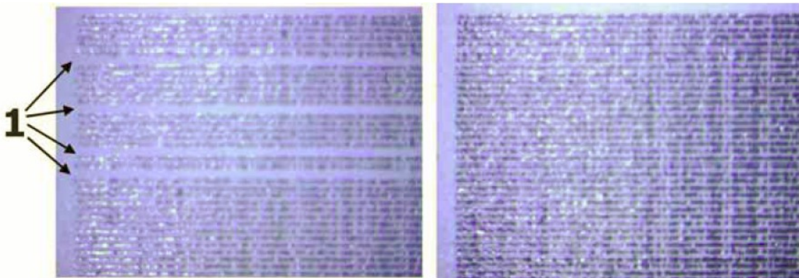
Плохое состояние сопел
