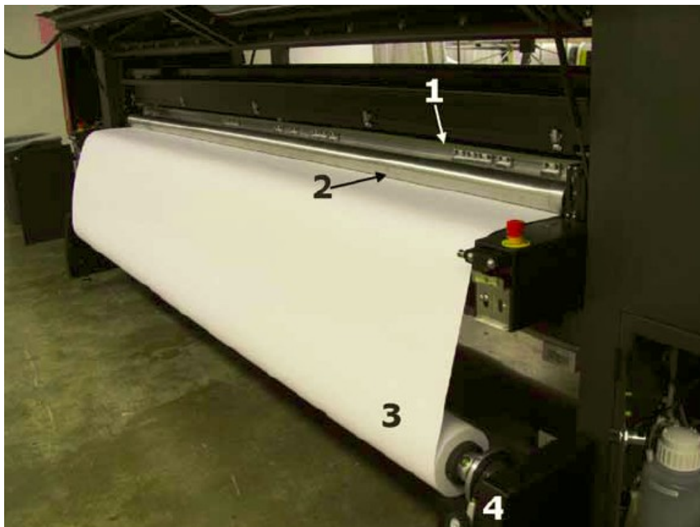
Рисунок 3-28: Размотчик рулонного материала, вид принтера сзади
