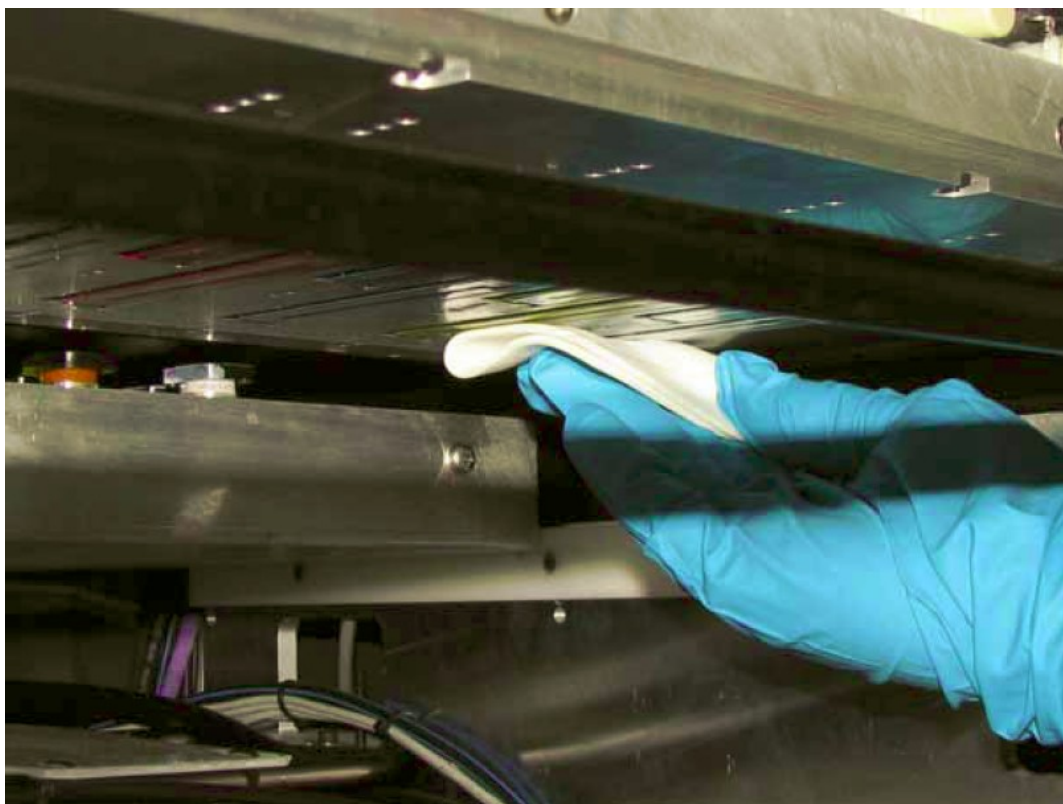
Рисунок 5-3: Протирка поверхности печатной головы
