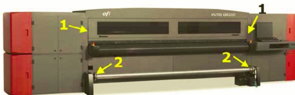
Рисунок 2-3: Вероятная опасность в передней зоне принтера и опасность удара
