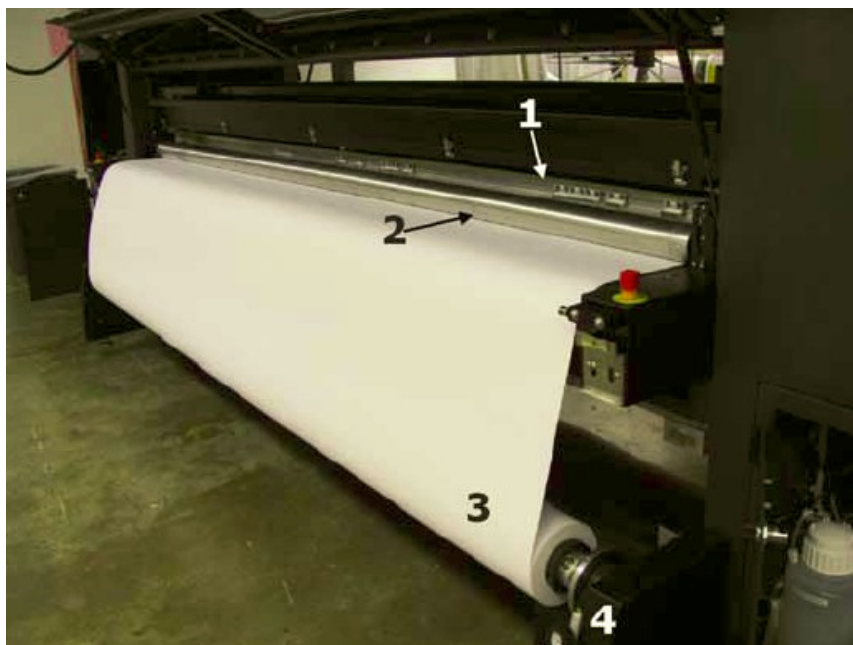
Рисунок 4-6: Устройство размотки/намотки рулонного материала
