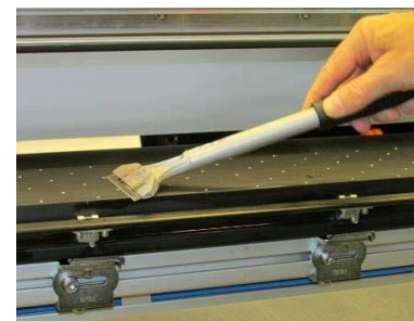
Рисунок 5-2. Чистка печатного стола.
