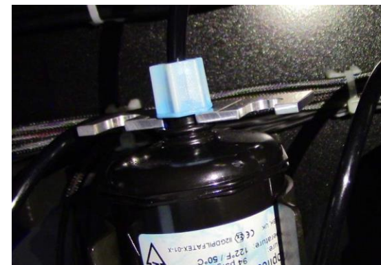
Рисунок 10-5. Правильное положение ограничителя на фильтре
