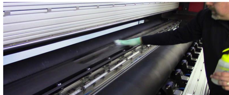
Рисунок 5-2. Чистка печатного стола.
