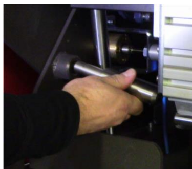
Рисунок 1-1 Открытая кожух (слева), установка стопора (посередине) и стопор установлен, (справа)
