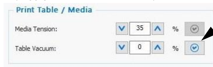
Рисунок 5-1 Настройка вакуума на печатном столе
