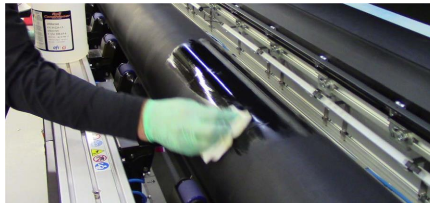
Рисунок 7-2 Чистка резинового Т-ролика
