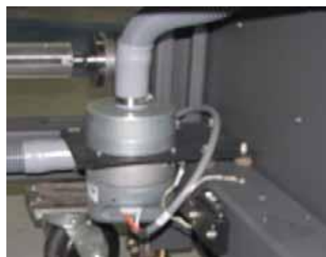
Рисунок 3-20: Вакуумная помпа, расположена под конвейерным ремнем
