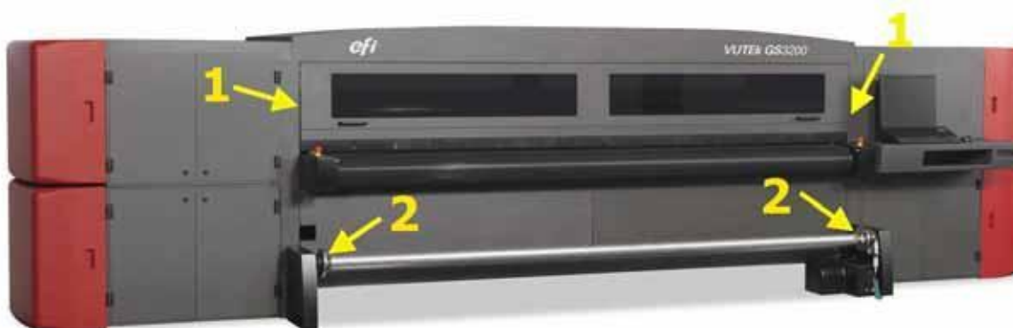
Рисунок 2-3: Места вероятной опасности в передней зоне принтера, где может произойти наматывание или раздавливание
