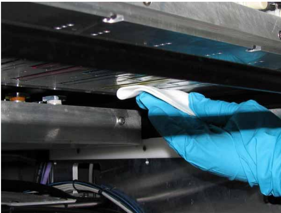
Рисунок 9-2: Протирка губкой поверхности голов
