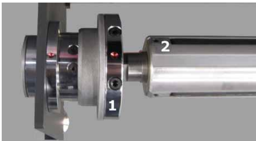
Рисунок 6-2: Размотчик/смотчик с закрытой защелкой вала
