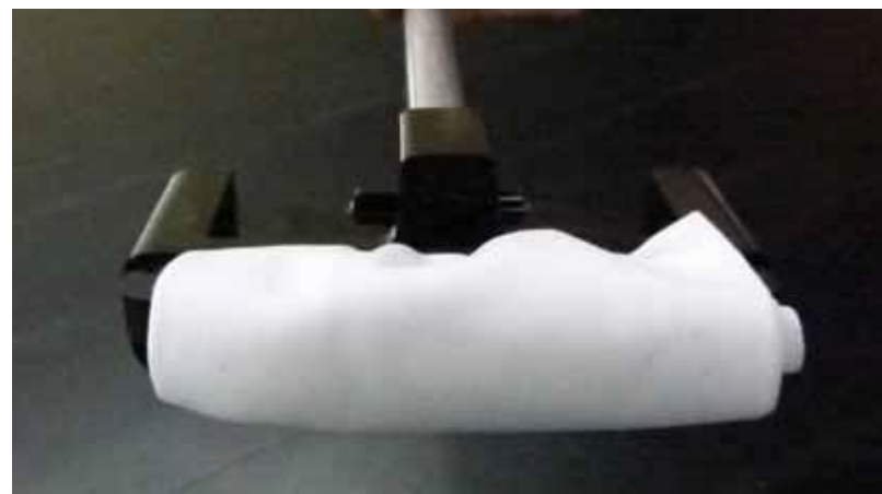
Рисунок 2-27: Салфетка на краю инструмента для чистки
