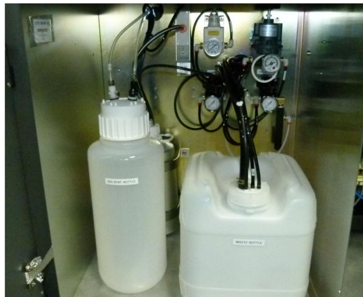
Рис 6-4: Отсек со сливной канистрой
