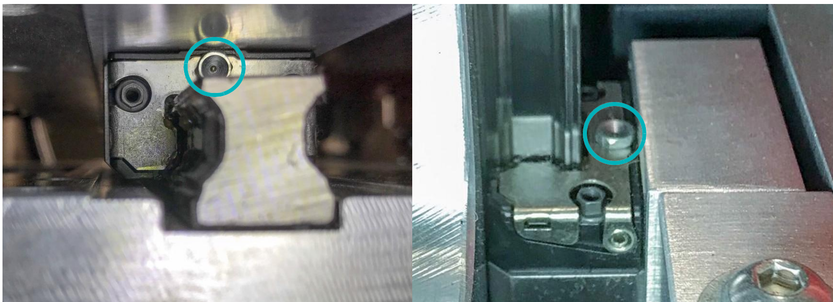
Рисунок 2-51: Верхний подшипник лифта (слева) и вид сбоку (справа)
