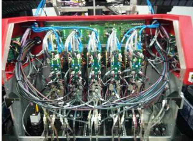
Отсоедините кабели от нужного блока к задней стенке, синие кабели передачи данных, а также прочие кабели, которые могут помешать поднимать блок вверх.
