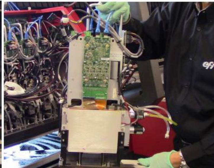
12. Установите снятый блок на подготовленную ранее платформу, зафиксируйте блок и платформу.
