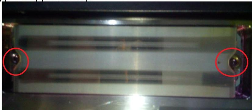
Откручивание винтов поднимает голову вверх. Постепенно открутите два винта, не допуская перекоса головы.
