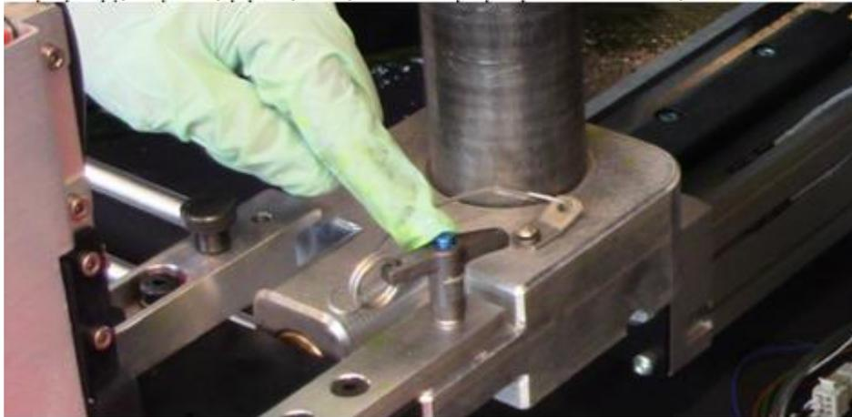
Правый фиксатор разрешает переворот, защелка слева фиксирует блок с головами на платформе.
