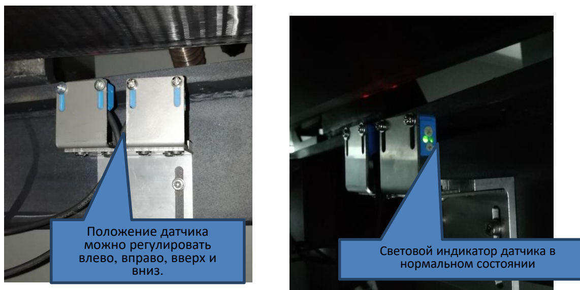
Рис. 48 Регулировка взаимного расположения сенсоров
