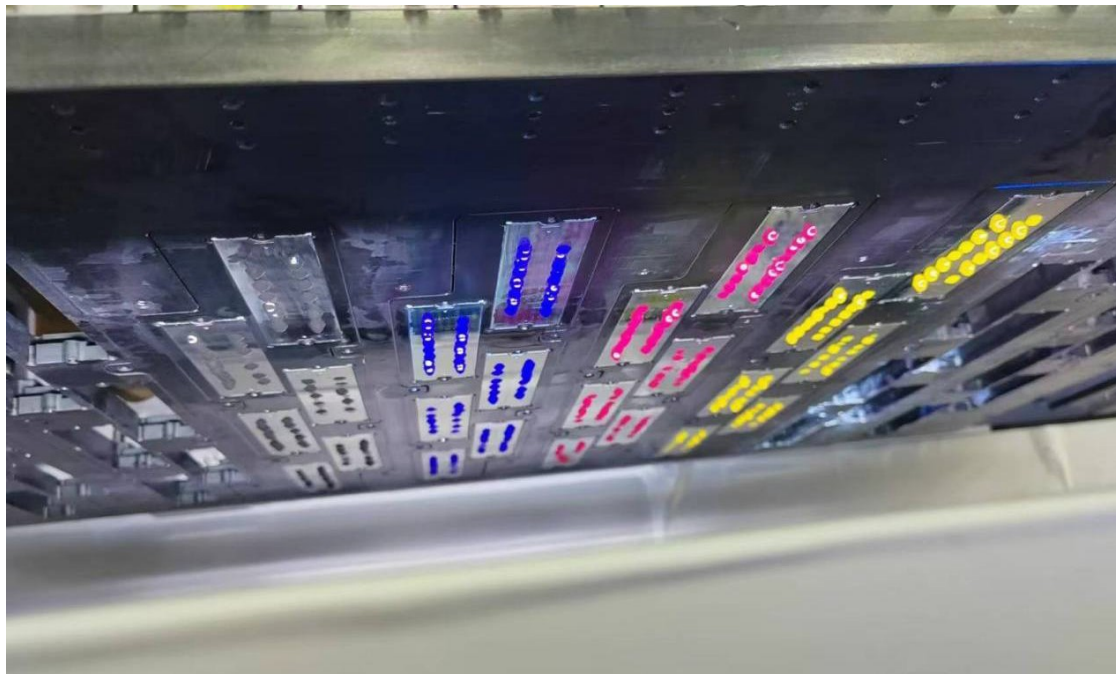
Рис. 208 Капли краски на поверхности голов
