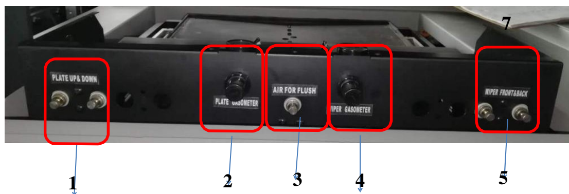
Рис. 50 Задняя сторона системы автоматической чистки
