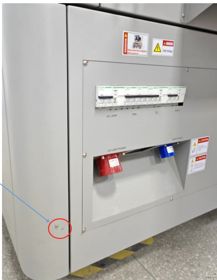
Рис. 34 Точки заземления принтера
