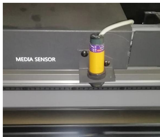
Рис. 42 Выключатель датчика конца рулона
