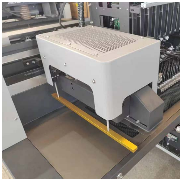
Рис. 207 Датчики защиты от удара стоят с обеих сторон каретки
