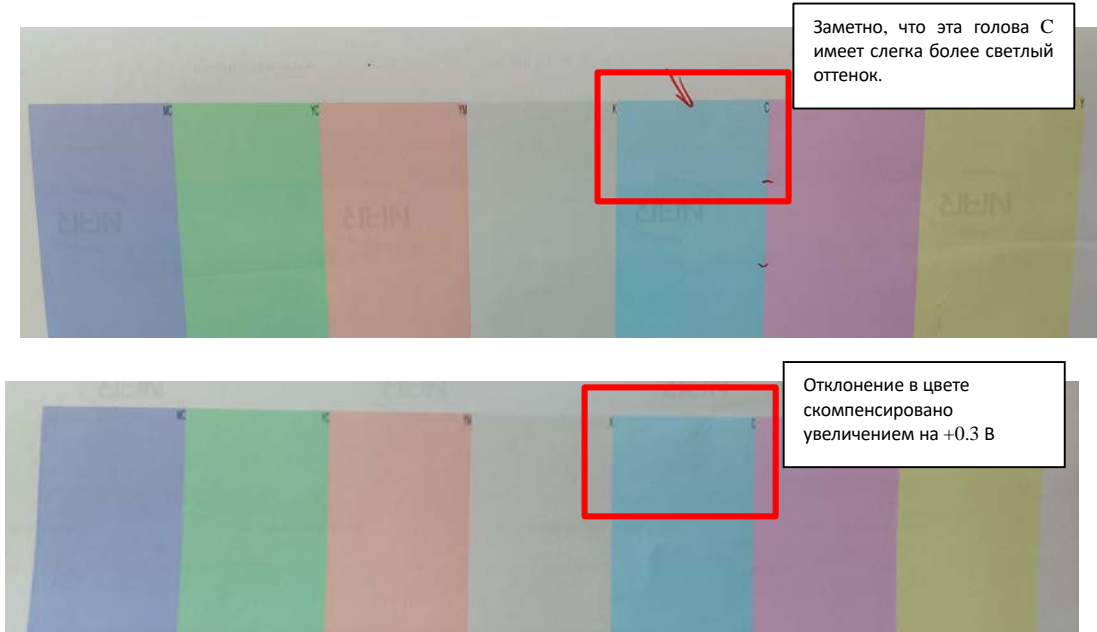
Рис. 182 Тест настройки плотности
