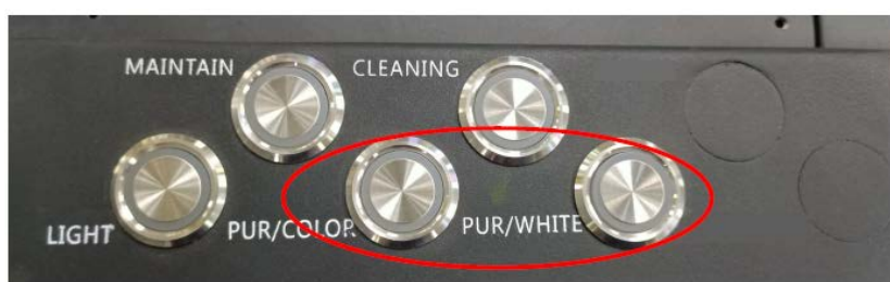
Рис. 56: Кнопка проливки голов краской
