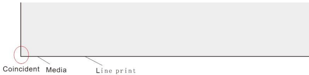
Рис. 78: Начало печати смещено только по X-оси
