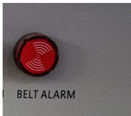
Рис. 7: Индикатор аварийного смещения ремня
