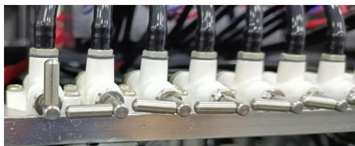
Рис. 55: Первый кран в положении «Print»
