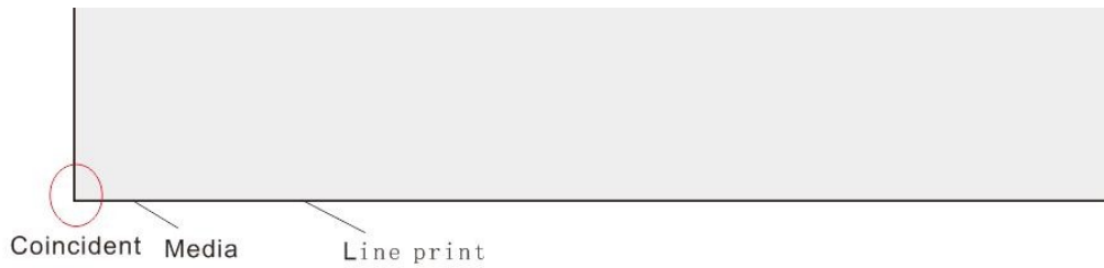
Рис. 79: Начало печати настроено идеально без смещения
