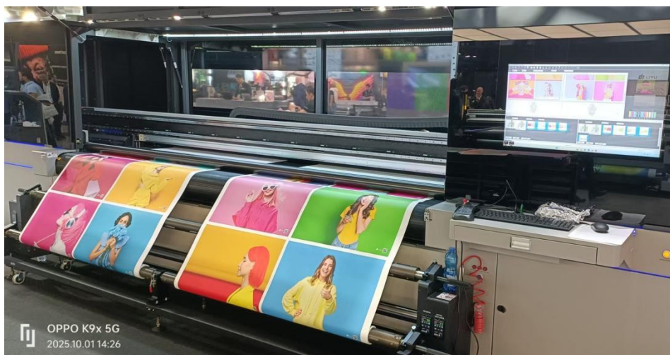
Рис. 66: Смотчики для двух рулонов материала
