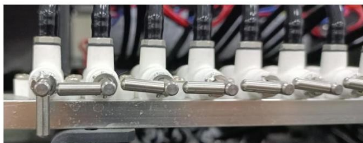
Рис. 52: Первый трехходовой кран в положении «Clean»
