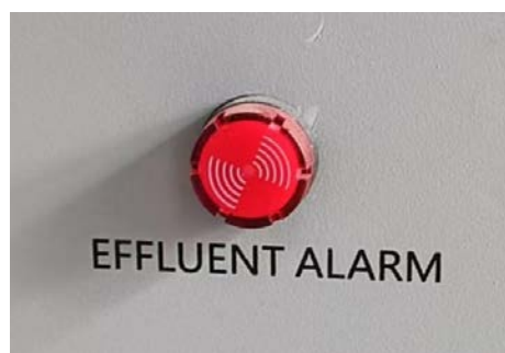
Рис. 6: Индикатор заполнения сливной канистры
